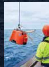
德国公司 K.U.M.Offshore 已向 INEOS 的 Nini 平台提供了八台 300 公斤重的 NAMMU 地震检波器, 用于监测地震活动
